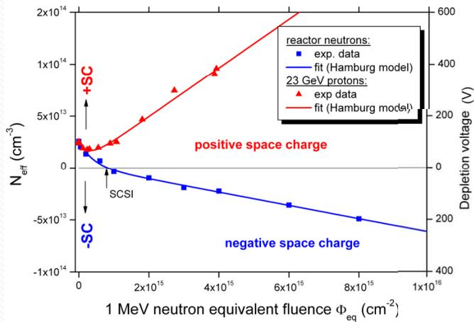
Epitaxial silicon (EPI-DO, 72 $\mu\text{m}$ , 170 $\Omega\text{cm}$ , diodes)
